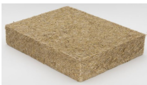
L'isolant en paille de riz de FBT ISOLATION en panneaux de 45 à 200 mm de lambda 0,039 - document FBT ISOLATION
