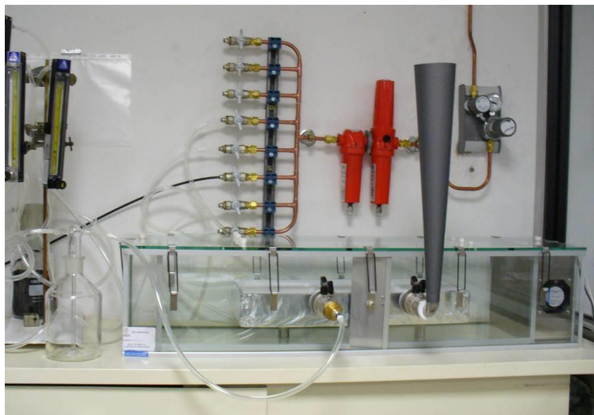
Figure 1 : Chambre d'essai d'émission avec éprouvette
